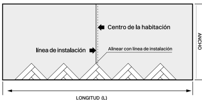
Coloque los triángulos con su lado largo hacia la pared de inicio.
