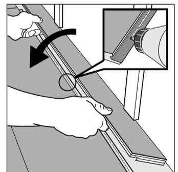
Retire el elemento de bloqueo según la imagen. Use el pegamento aplicable para conectar las tiras. Coloque cuñas entre la tira pegada.
