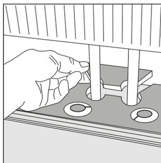
Perfore agujeros dos veces más grandes que el diámetro de las tuberías. Retire una pieza de la tira con un cuchillo o una sierra. Coloque la tira en un lado de las tuberías y la pieza retirada en el otro lado.
