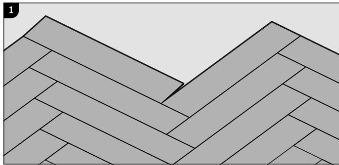
Las tablas deben bloquearse entre sí utilizando el sistema 5Gi. Para conectar una nueva tabla, debe usar un martillo de goma.
