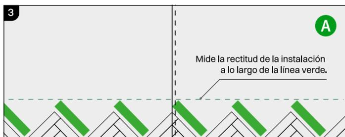
Instale las **tiras A** para conectar todos los triángulo. Las juntas entre la tira A y el triángulo deben verificarse con mucho cuidado. ¡No debe sentirse ningún borde sobresaliente!
