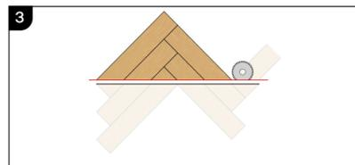
Corte el triángulo según la línea roja indicada. Dependiendo del tipo de sierra que use, puede ser útil desmontar el triángulo antes de serrar.
